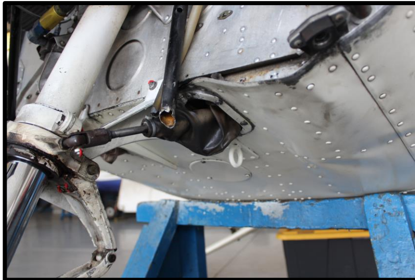
Fotografía No. 10 Daños en el fuselaje debajo de la pared de fuego.
