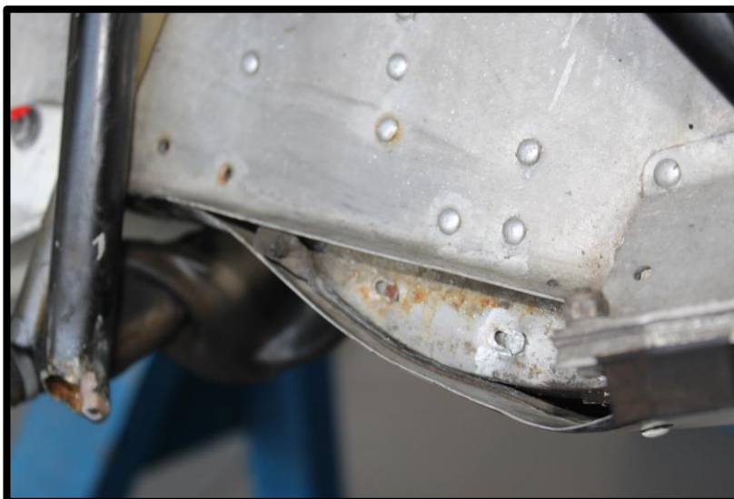
Fotografía No. 3 Remaches reventados y corrosión.
